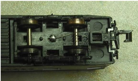
Abb: bedrahtetes Drehgestell mit Nietzapfen
