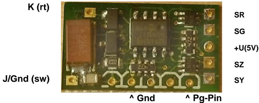
Der **DCC-Kleinsignaldecoder 9125** (21x12x3 mm) kann mit Hilfe seiner Ausgänge Signalbilder mit 4 LED darstellen als HV-, und KS Signalart. Allen Signalbildern einer Signalart sowie der Steuerung der Tag- Nachthelligkeit sind individuelle Steueradressen zugeordnet, die frei wählbar sind. Der Wechsel von HV-Signalbildern erfolgt durch weiches Umblenden. Alle Ausgänge schalten gegen Gnd. Die Baugruppe wird über den DCC- JK-Bus versorgt und gesteuert.
